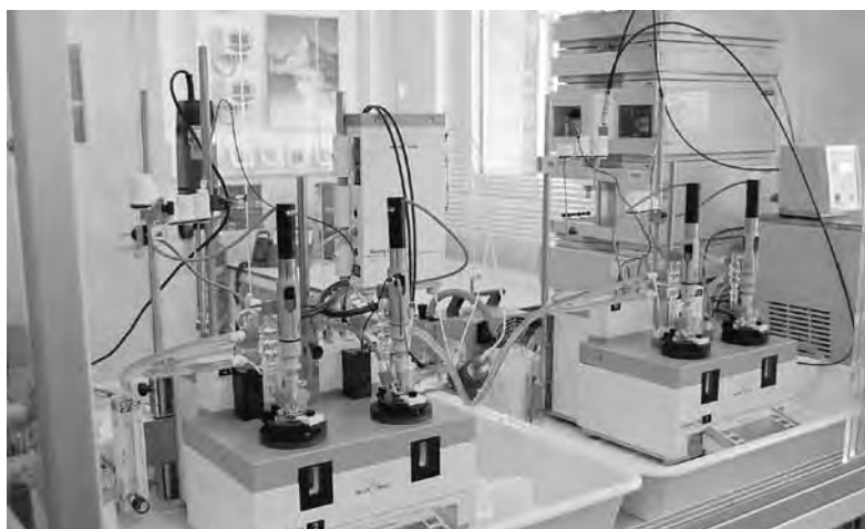
Grâce aux 2 stations EasyMax, Minakem a complètement automatisé ses réactions.
